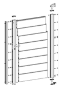
Système d'assemblage ultra-rigide OPTIMO
